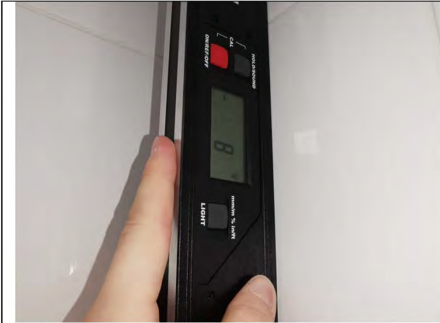
Фото №19. Измерение уровня стен в ванной комнате.
