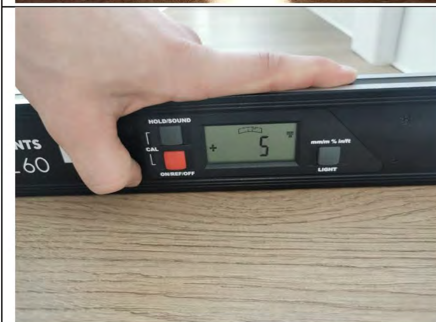
Фото №39. Измерение уровня пола в гостиной.
