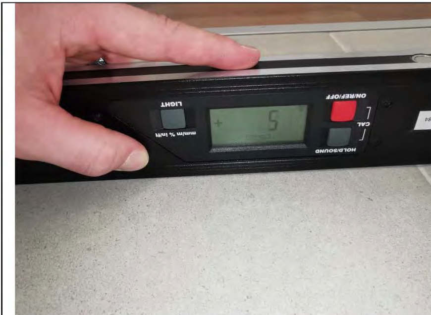
Фото №40. Измерение уровня пола в санузле.
