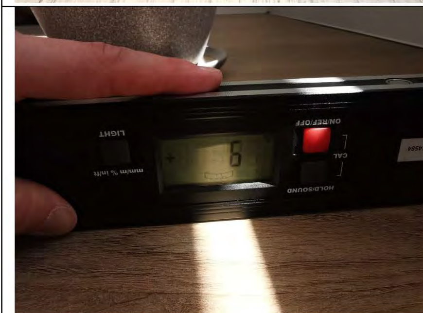
Фото №38. Измерение уровня пола в спальне.
