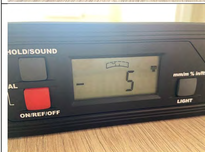
Фото №24. Отклонения поверхности напольного покрытия из ламината в гардеробной.
