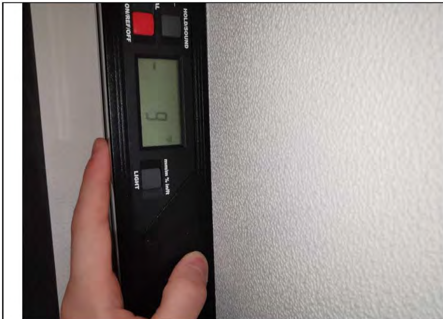
Фото №7. Измерение уровня стен в коридоре.
