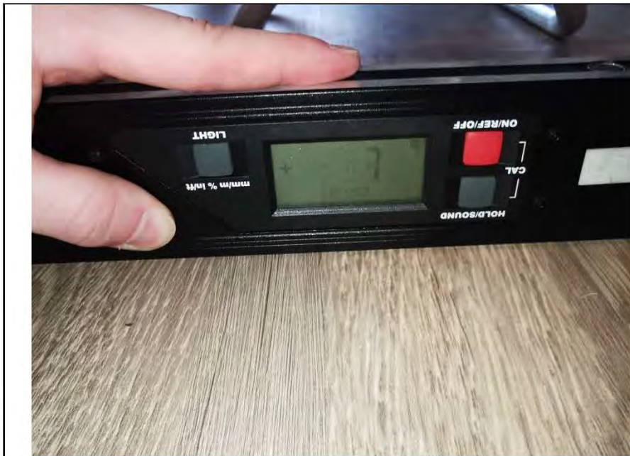
Фото №22. Измерение уровня пола в кухне.
