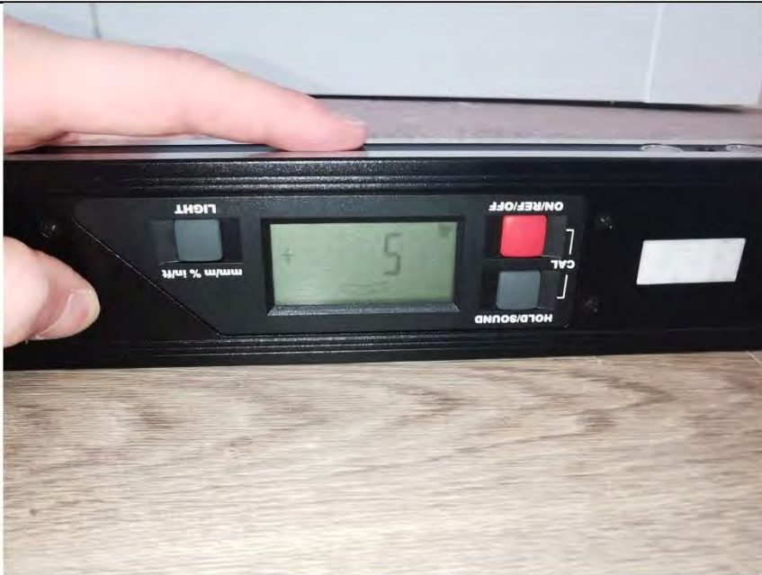
Фото №21. Измерение уровня пола в спальне.
