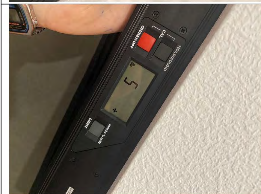
Фото №9. Измерение уровня стен в коридоре.
