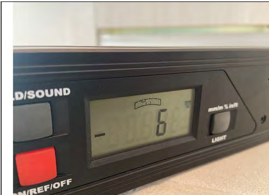
Фото №10. Отклонения на напольном покрытии из керамической плитки в коридоре.
