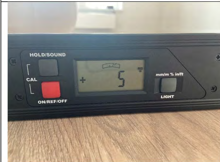
Фото №9. Отклонения на напольном покрытии из ламината в комнате.
